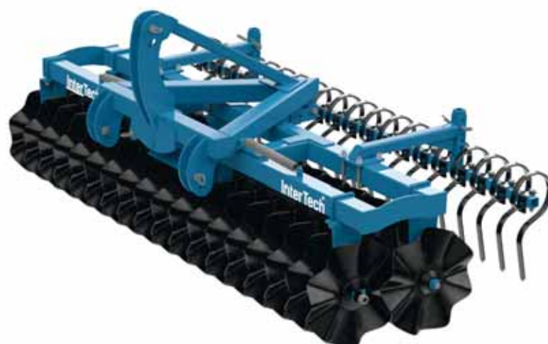
Agregat uprawowy przedni kruszy i rozdrabnia glebę na głębokość do 15 cm
