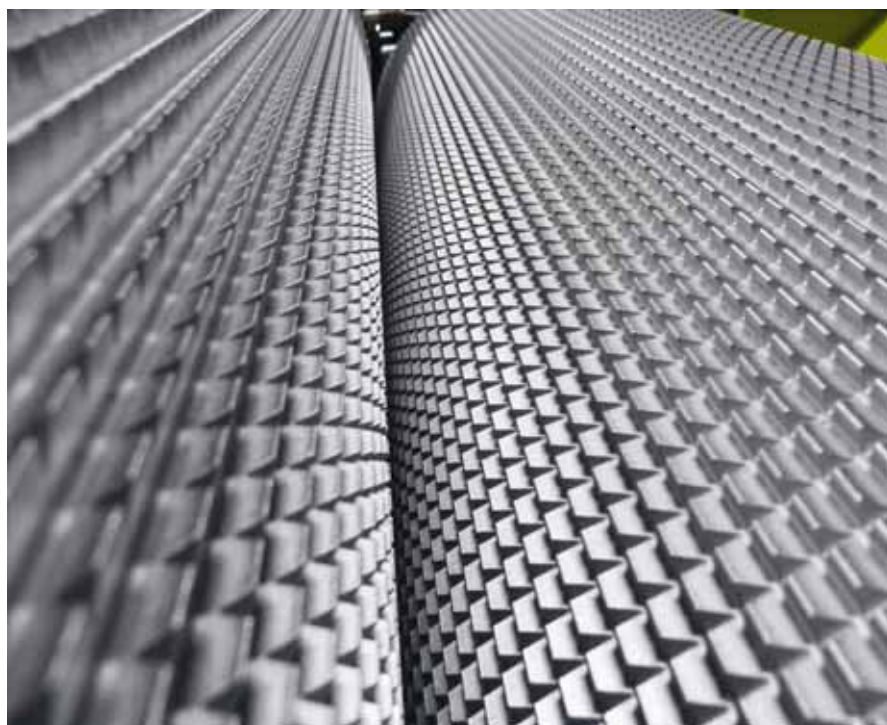
Stosowany w technologii SHREDLAGE unikalny zgniatacz ziaren Corncracker
