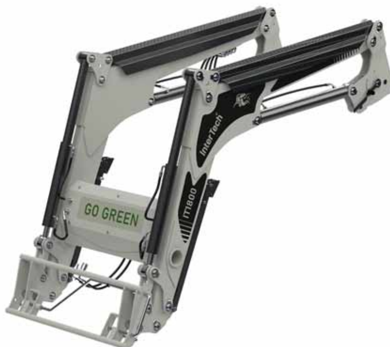
Ładowacz IT 1800 Green Power to najnowszy i najmocniejszy model linii produktowej Loader
