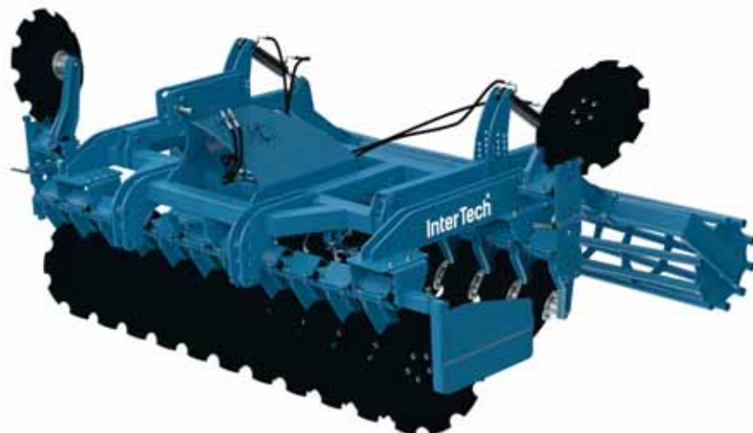
Brona talerzowa ciężka spulchnia glebę do głębokości 15 cm
