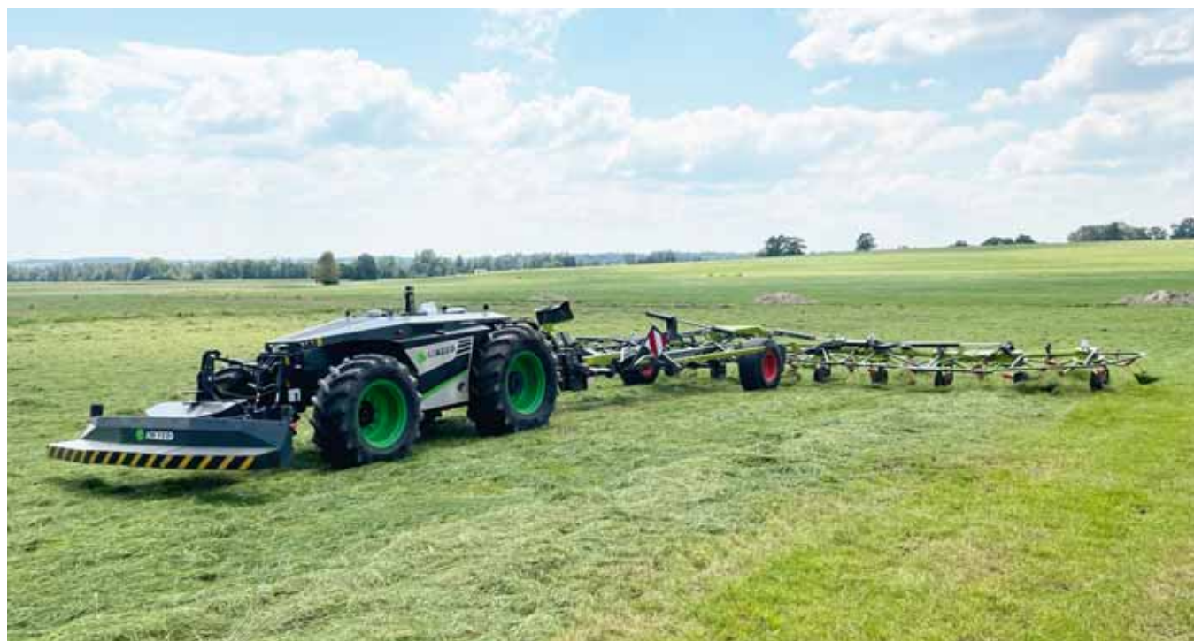
Autonomiczny zestaw do zbioru zielonek: AgBot, kosiarka czołowa i roztrząsacz karuzelowy
