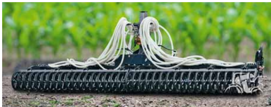
Brona talerzowa hydrauliczna z aplikatorem łączy w jednym przejeździe podorywkę z aplikacją gnojowicy
