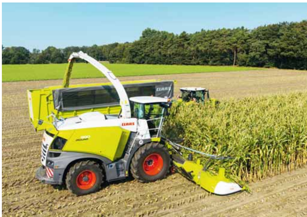
Najnowsza seria siewczarni Jaguar marki CLAAS jest wyposażona w unikalną technologię kondycjonowania paszy SHREDLAGE
