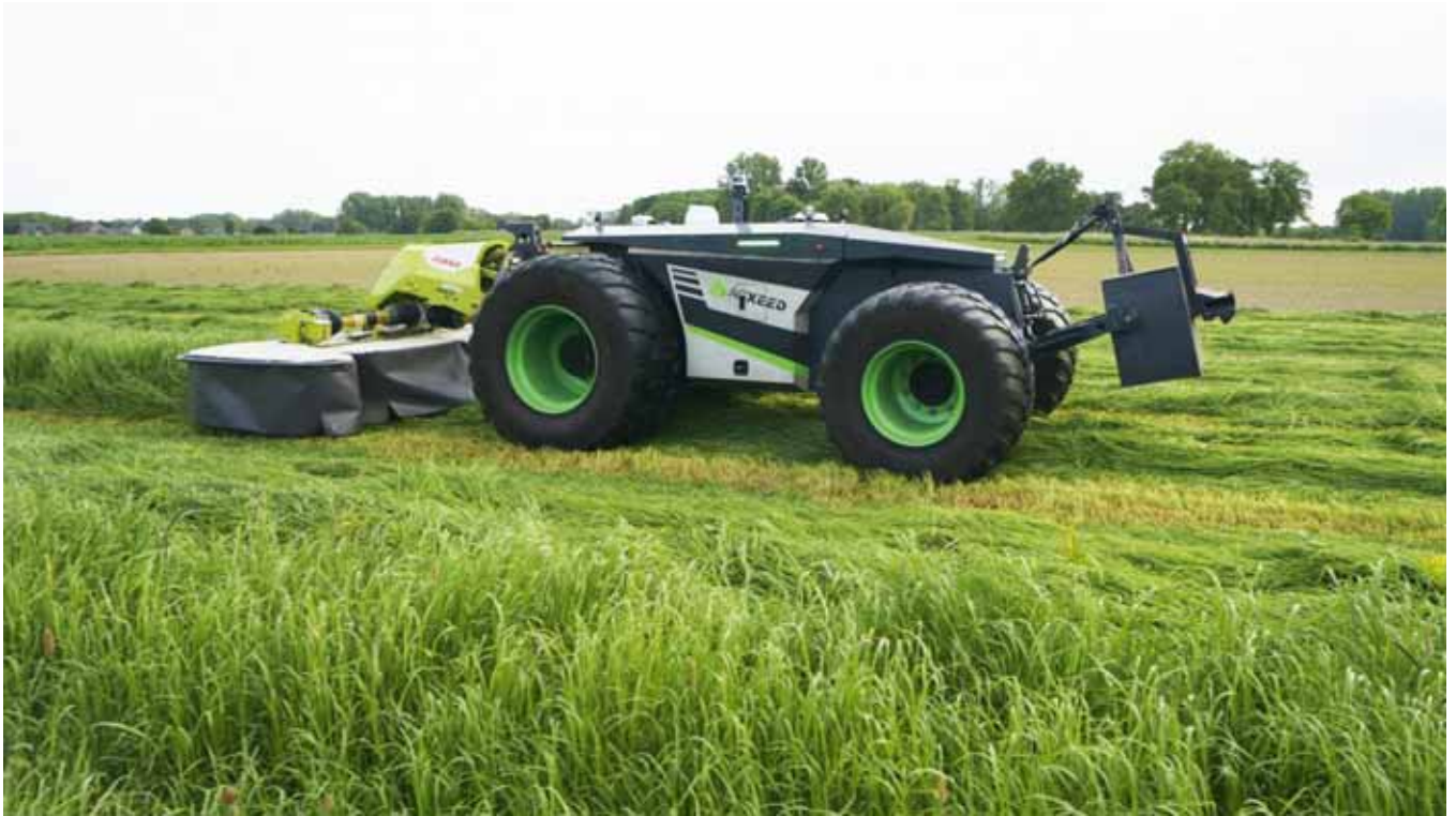
Opracowany w ramach wspólnego projektu firm CLAAS, AgXeed i thermal DRONES AgBot – autonomiczny nośnik narzędzi przeznaczony do zbioru zielonek
